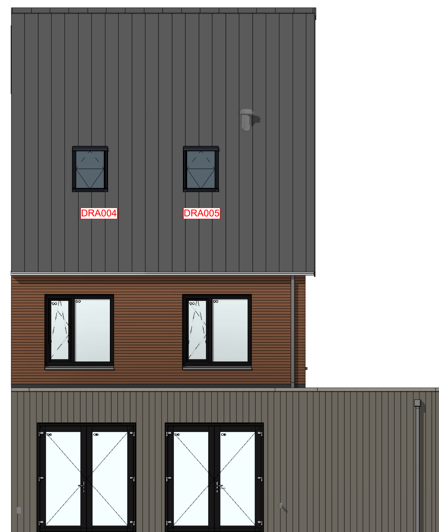
DRA004 - Dakraam in de achtergevel t.p.v. onbenoemde ruimte, afm. 780x1400mm (bouwmuurzijde) DRA005 - Dakraam in de achtergevel t.p.v. onbenoemde ruimte, afm. 780x1400mm (zijgevelzijde) 205007 - Buitenkraan in achtergevel
